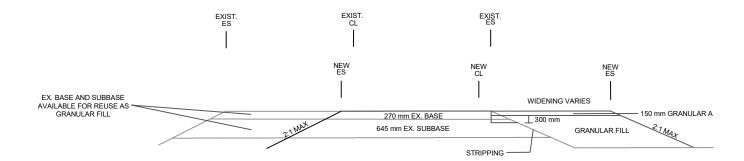
TYPICAL FILL SECTION - GRADING
